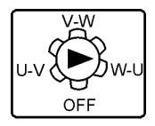
Figure 16. AC Voltmeter Change-Over Switch
